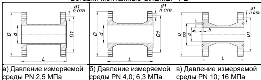
Рисунок Е.3 – Вставки монтажные ЭЛЕМЕР-РВ (тип присоединения к процессу «фланцевый»)
