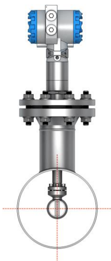
Рисунок 3.21 – Монтаж зондового расходомера
